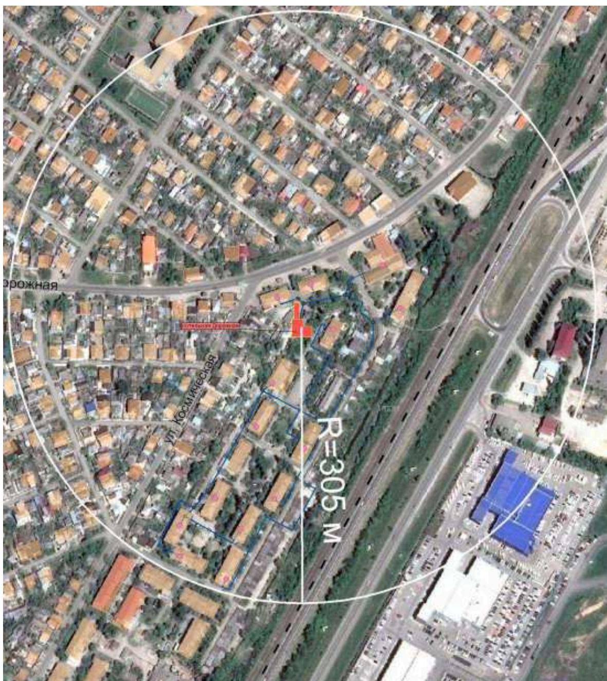
**Рисунок 1.4.1.10. - Радиус эффективного теплоснабжения котельной
