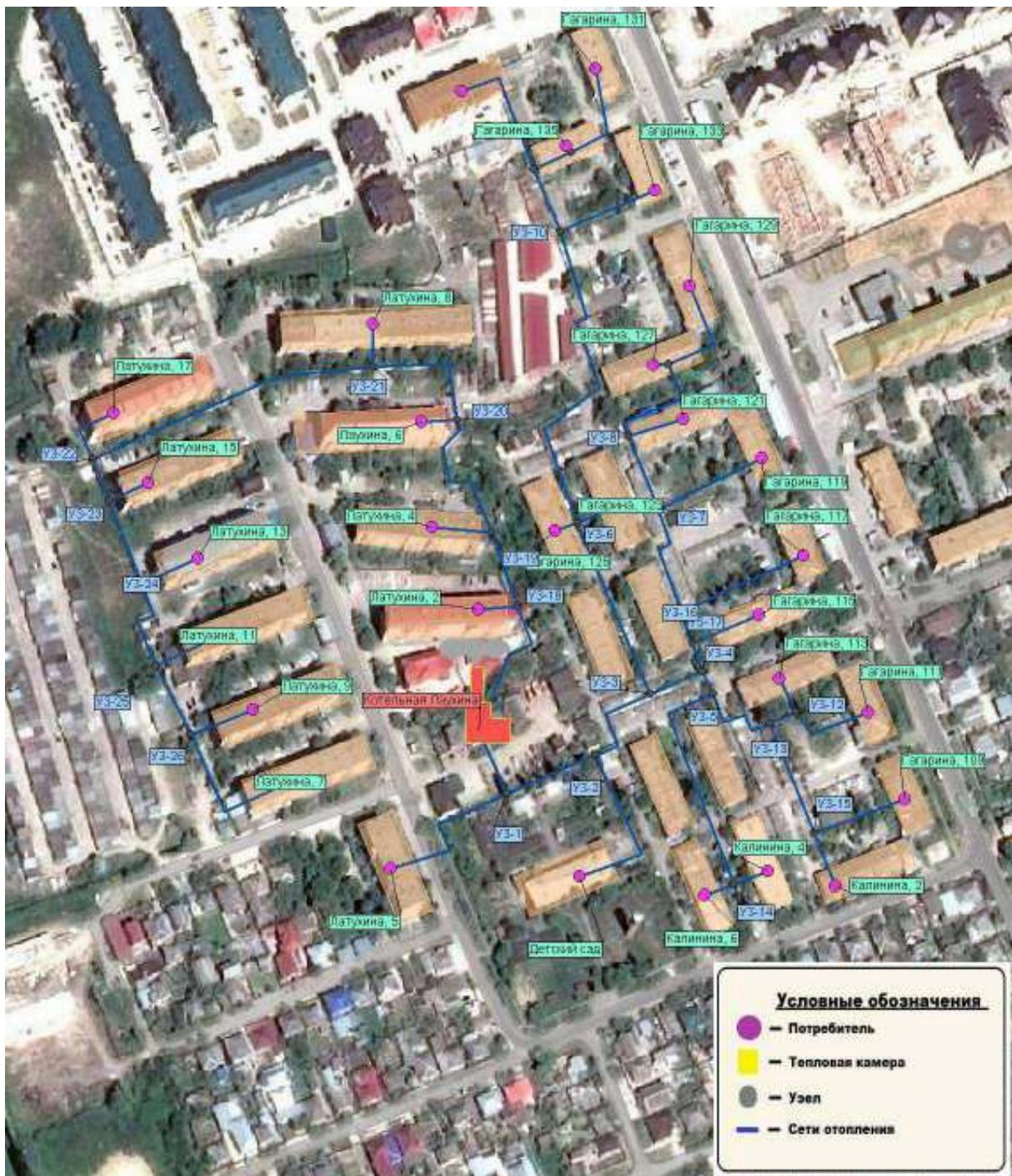
**Рисунок 1.3.2.2. - Схема тепловых сетей от котельной по ул. Лаухина**
