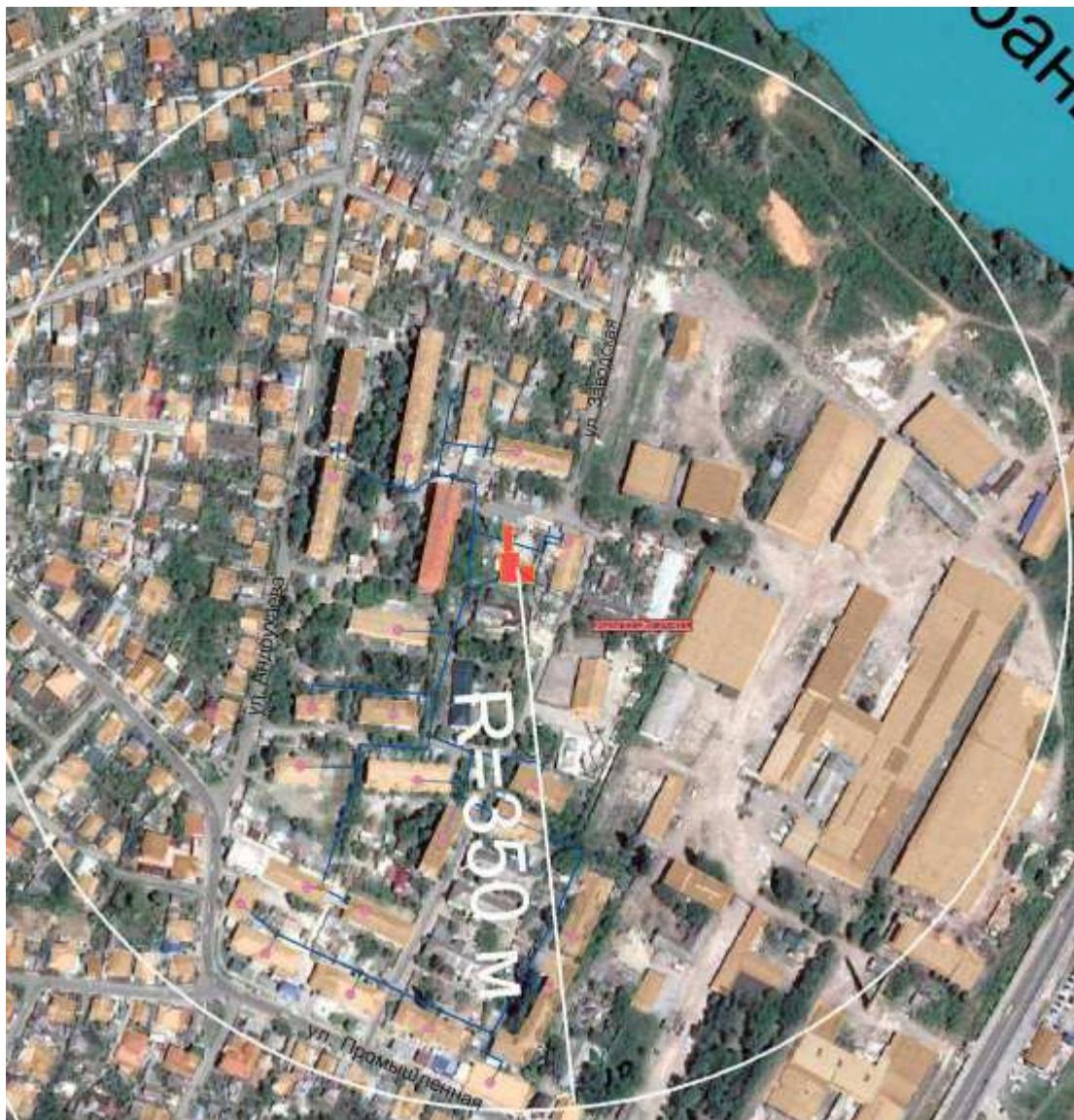
**Рисунок 1.4.1.12. Радиус эффективного теплоснабжения котельной
