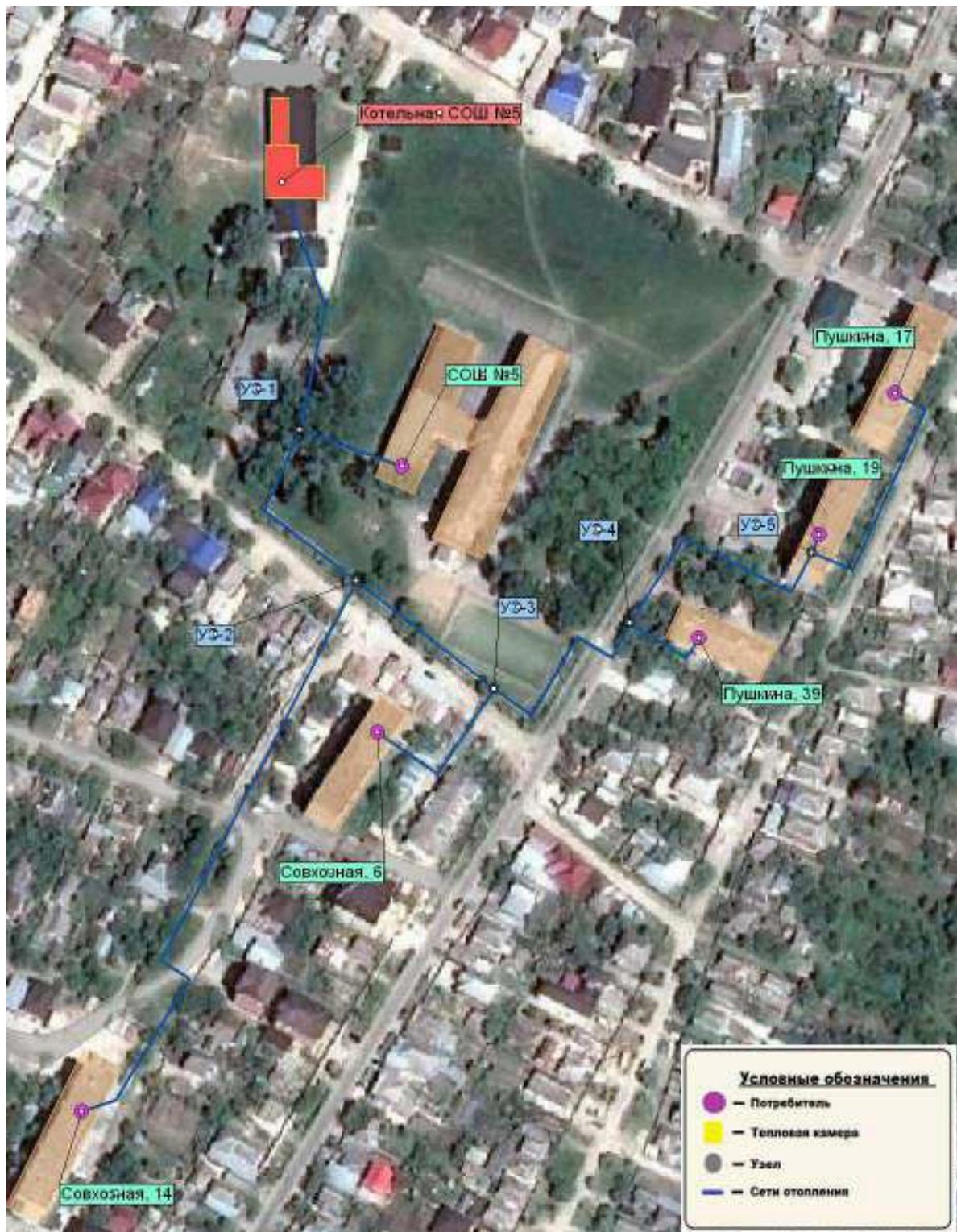
Рисунок 1.3.2.6 - Схема тепловых сетей от котельной по ул.
