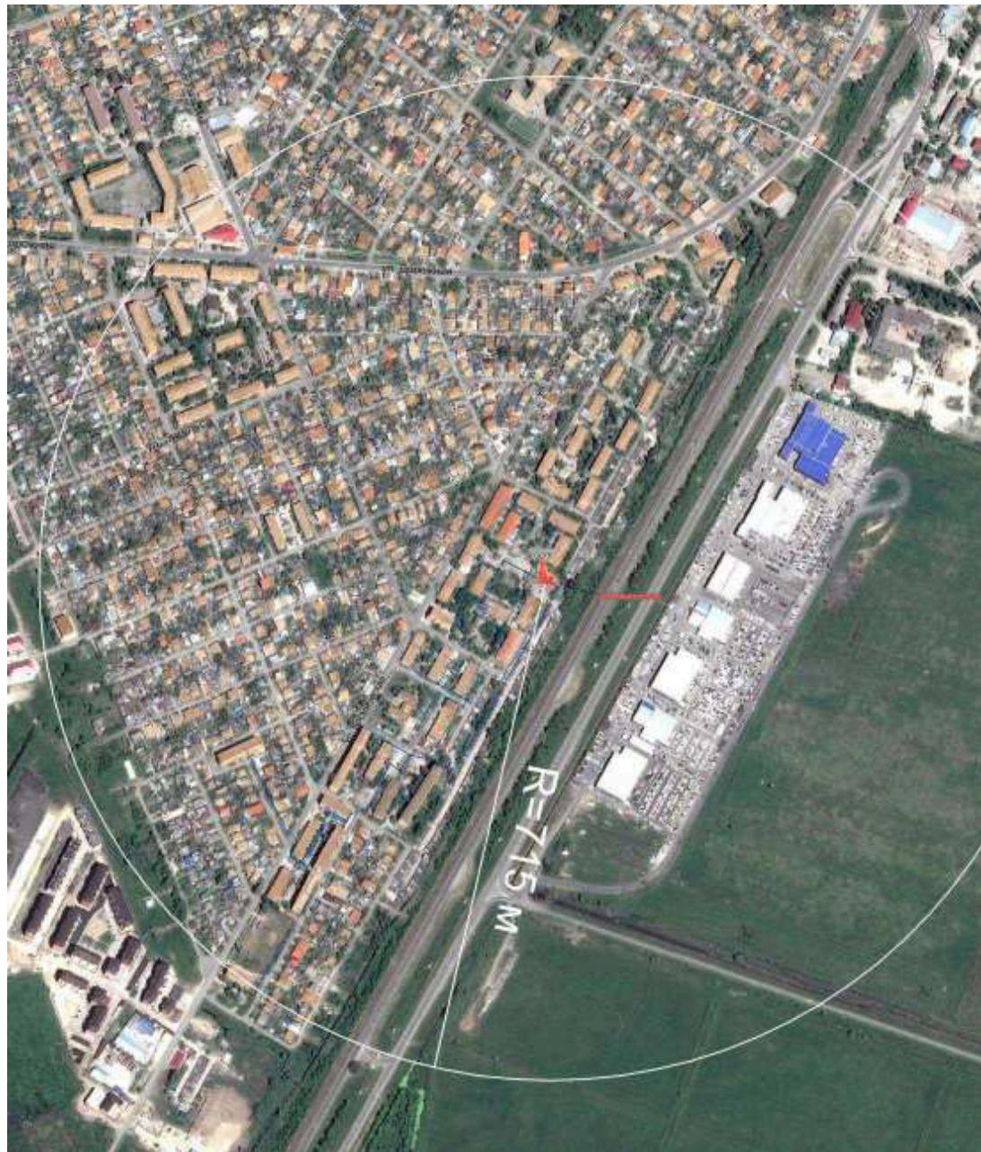
**Рисунок 1.4.1.14. Радиус эффективного теплоснабжения котельной
