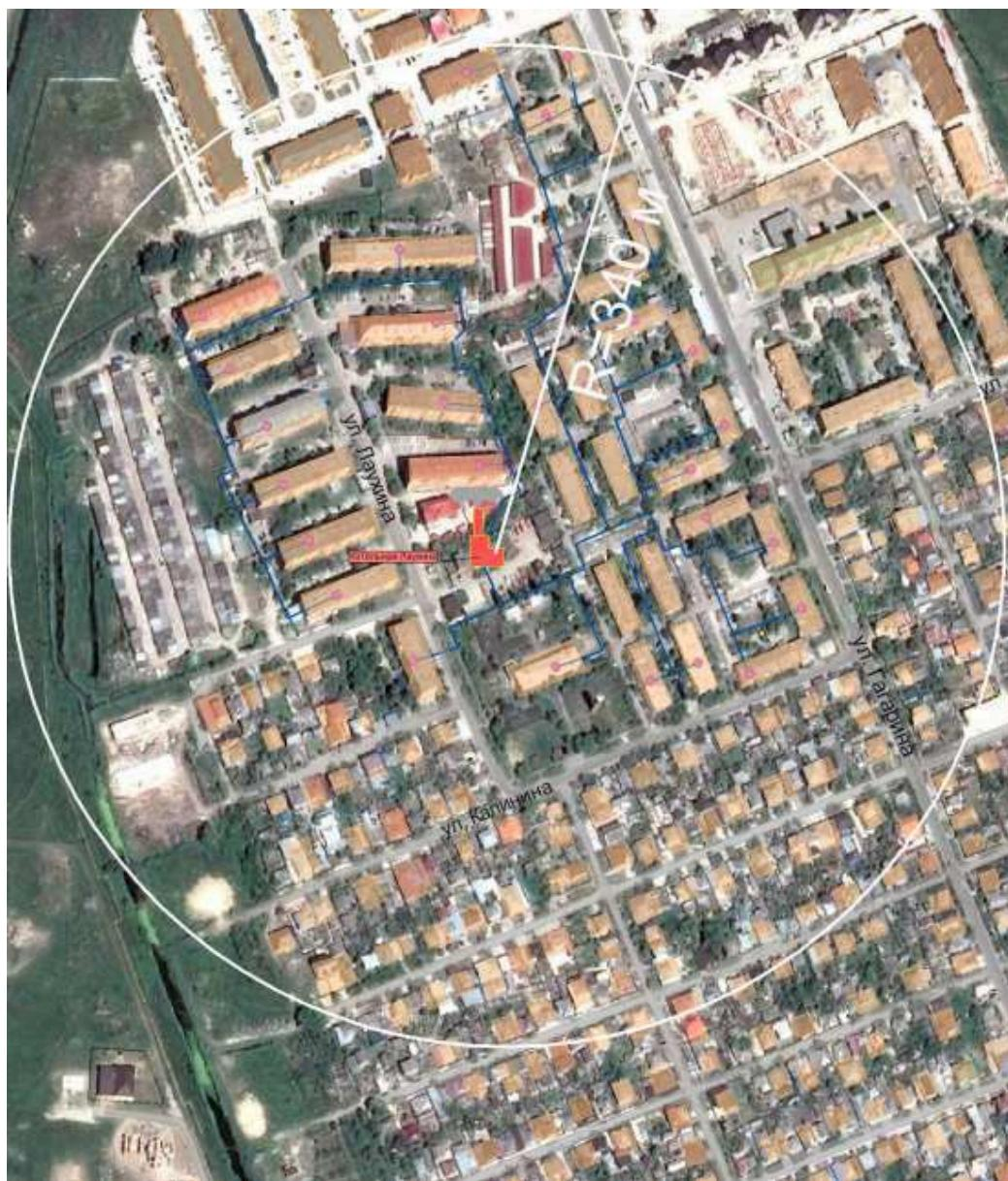
**Рисунок 1.4.1.9. - Радиус эффективного теплоснабжения котельной
