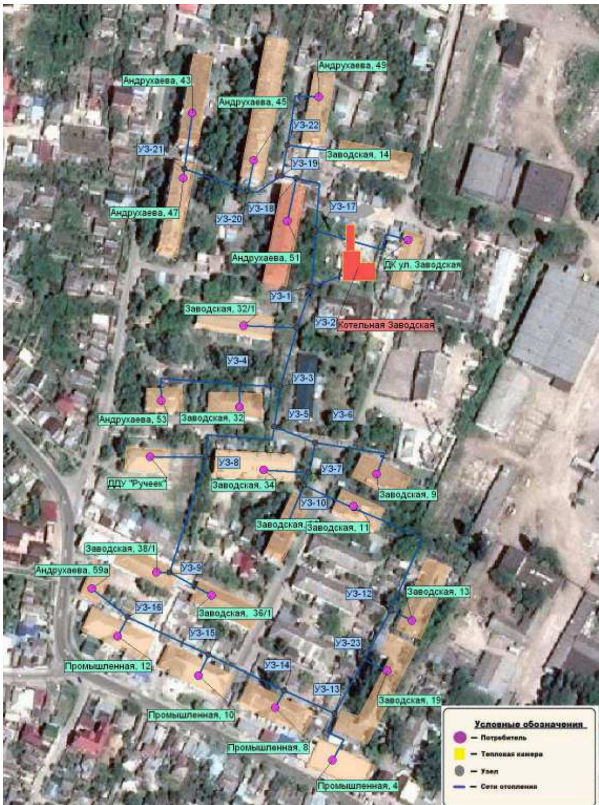
**Рисунок 1.3.2.5. - Схема тепловых сетей от котельной по ул.
