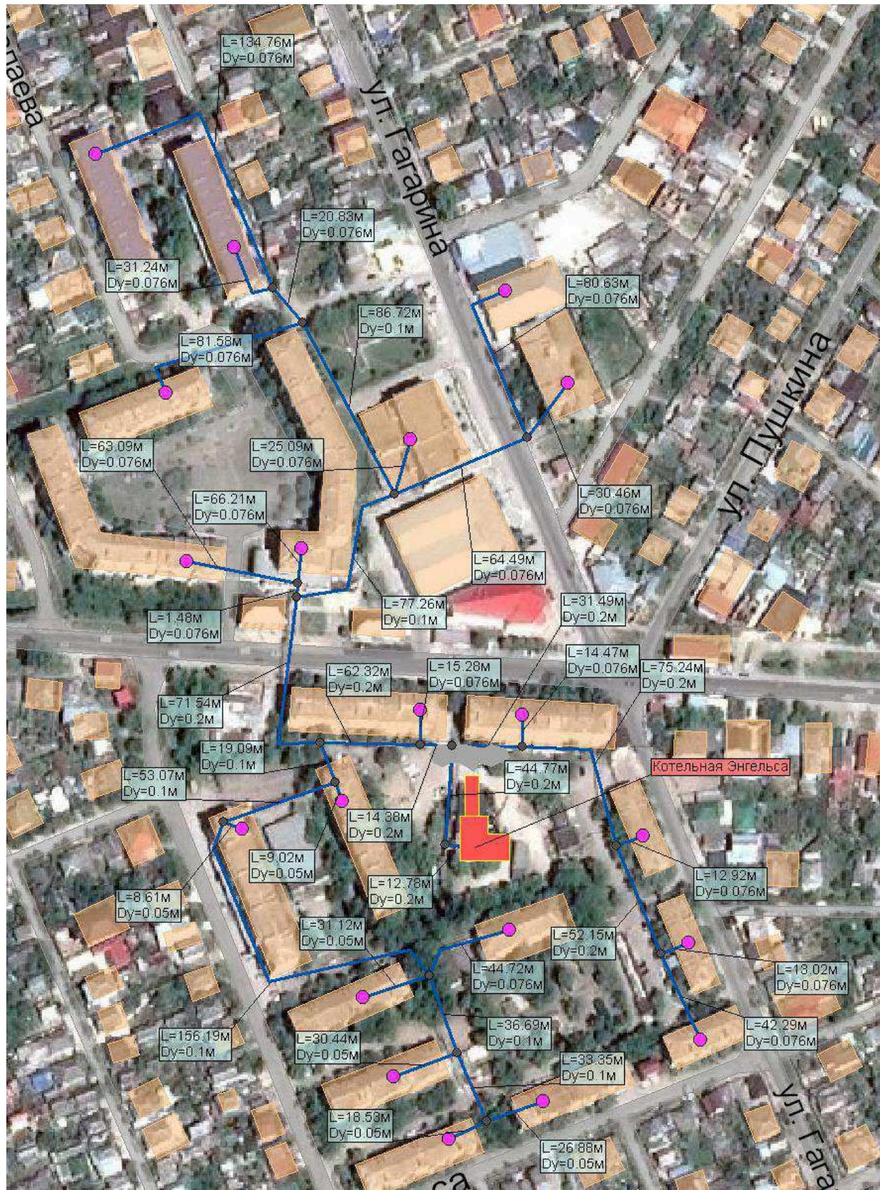
**Рисунок 1.3.2.4. - Схема тепловых сетей от котельной по ул. Энгельса**
