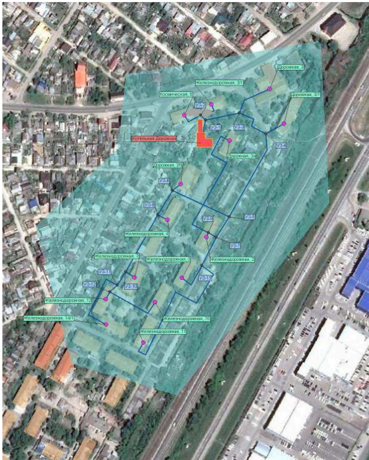
Рисунок 1.4.1.3. - Зона действия котельной по ул. Дорожная
