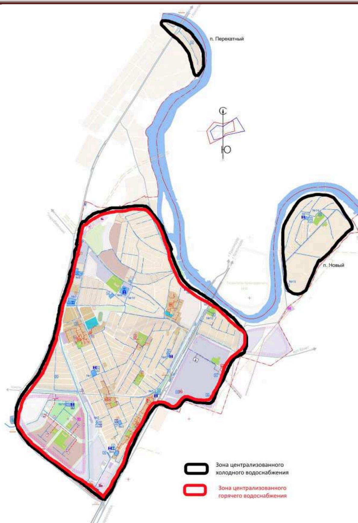
Рисунок 2.2.3.1 - Зоны действия централизованных систем водоснабжения
