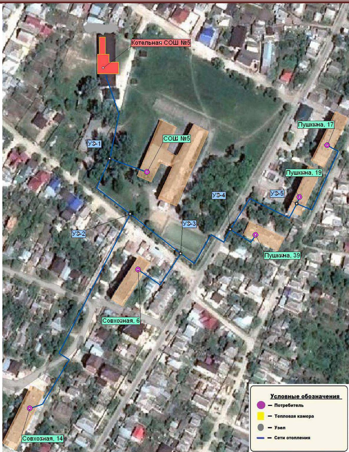
Рисунок 2.1.3.6 - Схема тепловых сетей от котельной по ул. Пушкина
