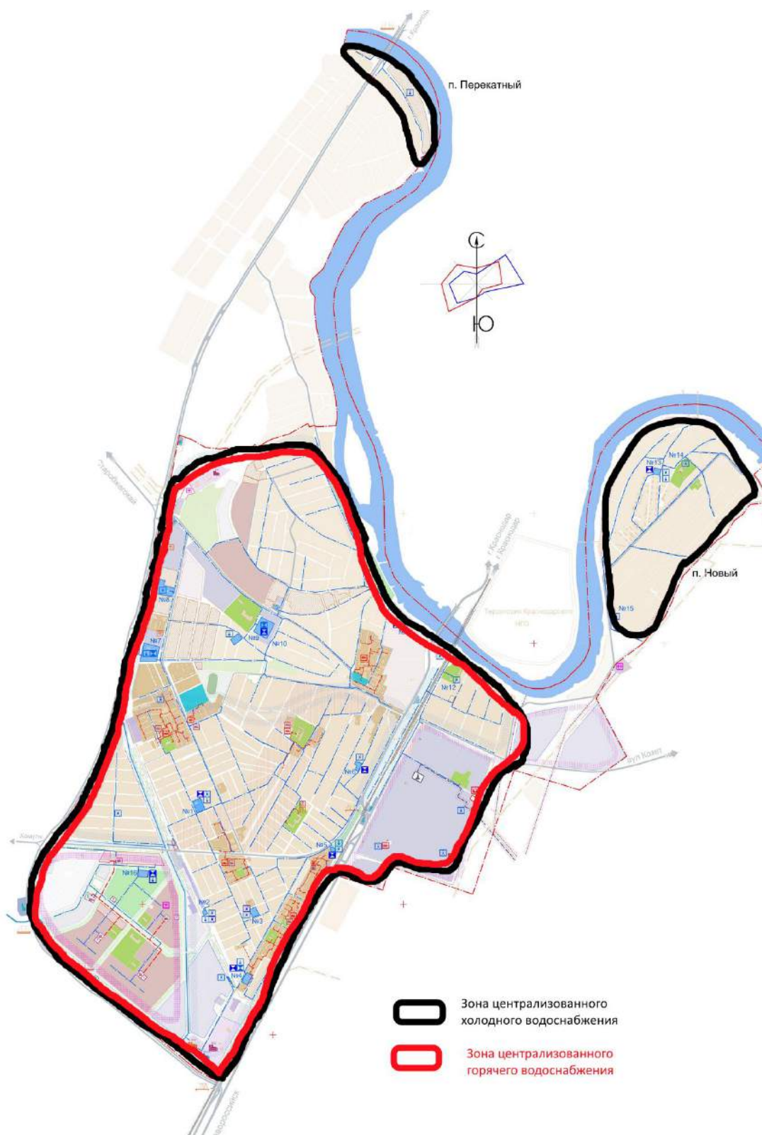
Рис. 2. Зоны действия централизованных систем водоснабжения.
